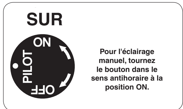
Fig. 28-1 Détail bouton de commande (SUR)
